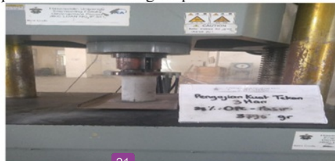
Gambar 4. Pengujian kuat tekan beton
