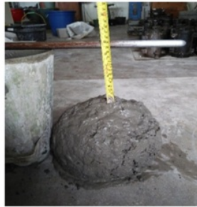
Gambar 3. Pengukuran slump beton segar
