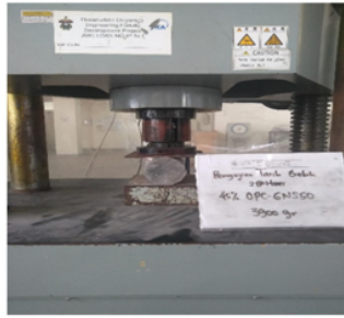
Gambar 6. Pengujian tarik belah belah beton
